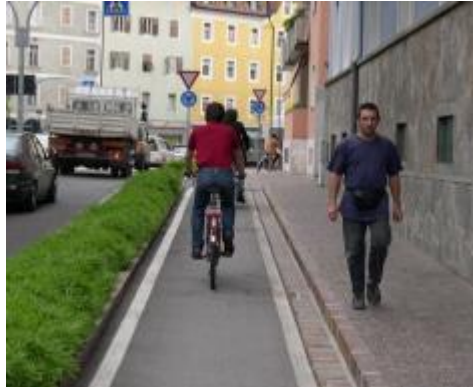
Fig. 4.12 – Esempio pista in sede propria
